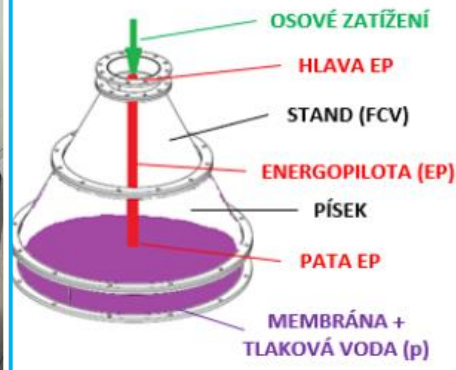
schéma zatěžovacího kuželu s energopilotou
