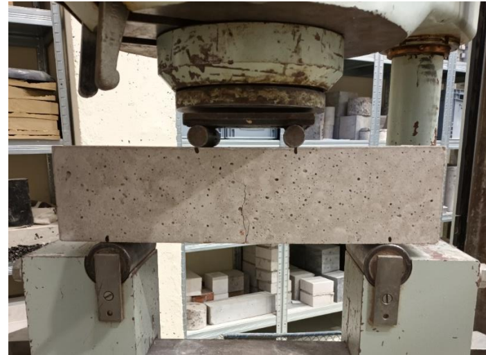
Obrázek: Zkoušky pevnosti v příčném tahu (100×100×400) mm
