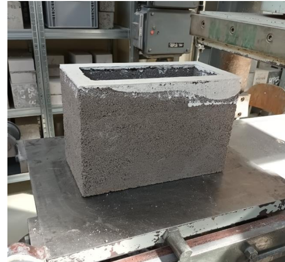
Obrázek: Příprava tvárnice pro tlakovou zkoušku
