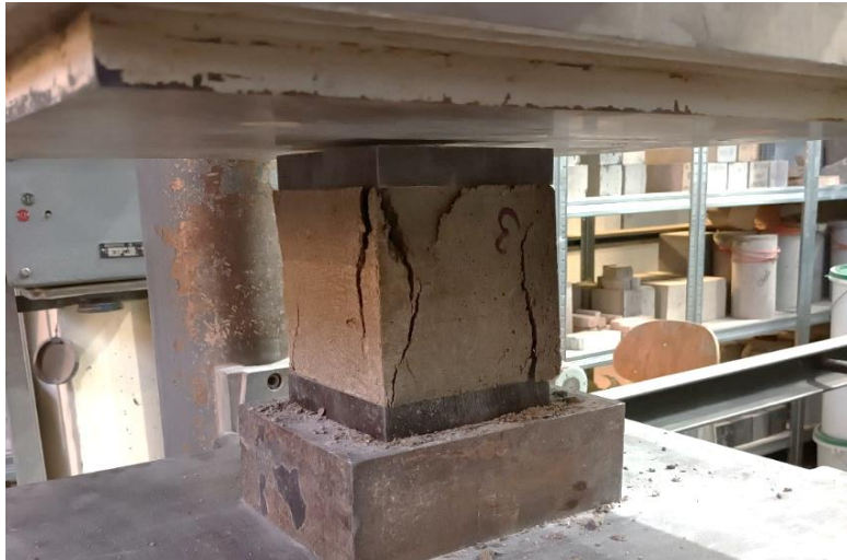
Obrázek: Zkoušky pevnosti v prostém tlaku (150×150×150) mm
