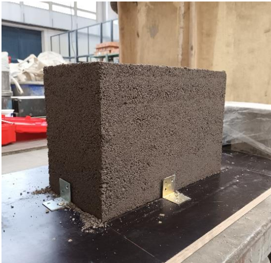
Obrázek: Kompletní odformování tvárnice
