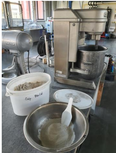
Plnivem pro omítku je odpad vznikající při výrobě Perlitu
