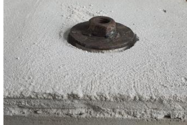
Zkoušení mechanických parametrů: pevnost v ohybu a tlaku, přídržnost k podkladu
