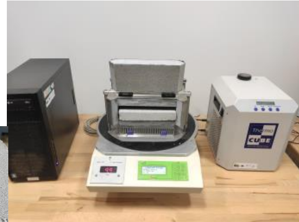
Mezi nejdůležitější zkoušené vlastnosti patří součinitel tepelné vodivosti
