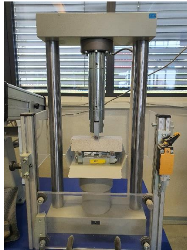
Zkoušení mechanických parametrů: pevnost v ohybu a tlaku, přídržnost k podkladu
